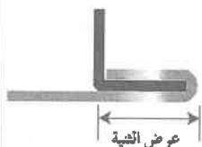
٣- الشكل المجاور يبيّن إحدى طرق ربط مجرى الهواء، وتشير الوصلة:
