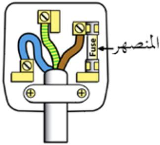
المنصهر: هو عبارة عن سلك فلزي رفيع محمول على جسم من مادة عازلة يسمح بمرور قيمة قصوى للتيار خلاله، وعند زيادة التيار الكهربائي المار عن هذه القيمة ينصهر السلك ويقطع التيار الكهربائي عن الجهاز لحمايته، وعادة يركب المنصهر داخل الجهاز أو في القابس.
