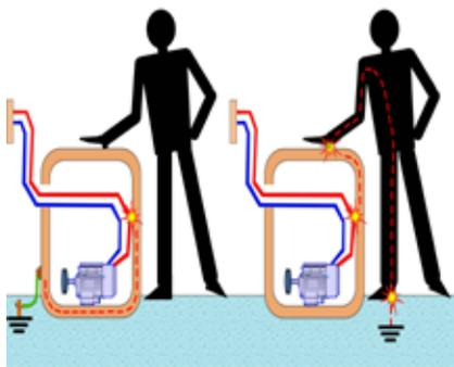
**التأريض:** عند تلف المادة العازلة التي تغلف السلك الحي بسبب عوامل مختلفة يتعرض السلك النحاسي وقد يلامس الغلاف الفلزي للجهاز، وعند الاستخدام يمر التيار الكهربائي عبر جسم الإنسان إلى الأرض، إذ يعدُّ جسم الإنسان موصلًا للكهرباء، مما يشكل خطورة كبيرة عليه، للتغلب على هذه المشكلة يوصل سلك نحاسي بين غلاف الجهاز والخط الثالث الموجود في القابس (الخط الأرضي) الذي يكون لونه أخضر في العادة يوصل المقابس جميعها معًا في المنزل ثم توصل مع قضيب نحاسي يدفن في الأرض.
