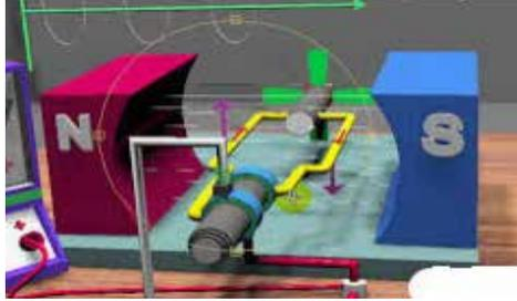
الشكل (6-6): المولد الكهربائي
