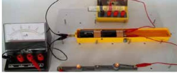
الشكل (1-4): الدارة الكهربائية لتجربة قانون أوم
