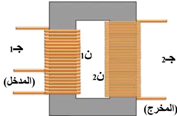
الشكل (6-8): أجزاء المحوّل الكهربائيّ
