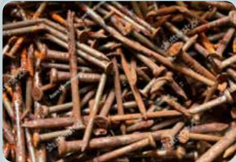
يعرّف الصدأ بأنه الطبقة الهشة الرقيقة التي تُغلف الحديد المعروفة بأكسيد الحديد، ذو التركيب الكيميائي ( $Fe_2O_3$ )، وينتج الصدأ نتيجة اتحاد الأكسجين مع الحديد وفق المعادلة الآتية:
